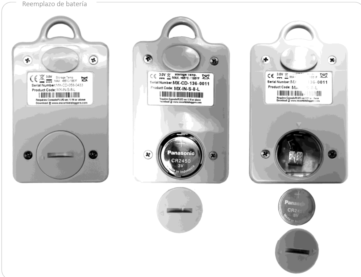
Reemplazo de batería
